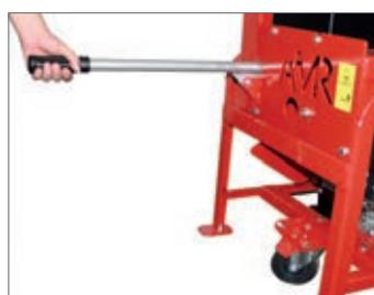
Poignée et 3<sup>ème</sup> roue pivotante de transport
