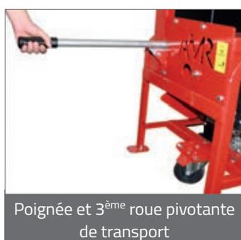
Poignée et 3<sup>ème</sup> roue pivotante de transport
