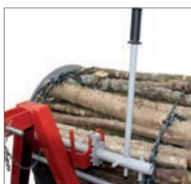
Mécanisme de serrage
