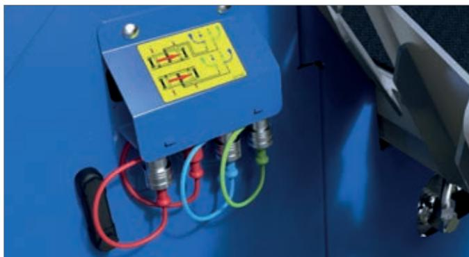
Sortie hydraulique pour deck ou autres accessoires.
