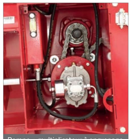
Pompe + multiplicateur à engrenage. Un filtre pression assure la pureté de l'huile
