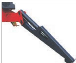
Vérins stabilisateurs avec soupapes de freinage intégrées
