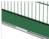
3- Poutre basse / Rail / Roue
