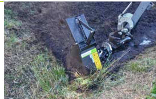
Cureuse de fossé GR 70
