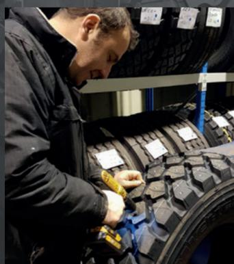
Clois à visser brevetés à pointe tungstène, rapide et facile d'installation et de désinstallation pour un usage sur neige, glace, terre et rocher.
