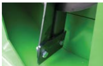
Pale d'éjection renforcée par une plaque de Hardox
