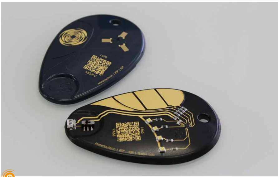
Démonstrateur de plastronique obtenu par le procédé LDS, sur lequel on retrouve d'un côté des pistes métallisées et des composants montés en surface, et de l'autre une antenne et un QR Code d'identification. Doc : Polyvia
