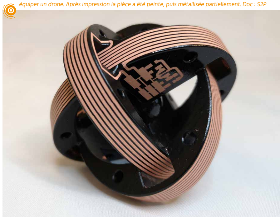
Inductance 3D réalisée par impression 3D pour une thèse sur la recharge par induction, destinée à équiper un drone. Après impression la pièce a été peinte, puis métallisée partiellement. Doc : S2P
