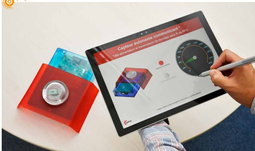
Démonstrateur de capteur autonome communiquant intégrant l'électronique dans le matériau polymère. Doc : Cetim
