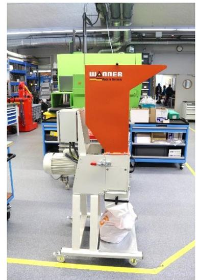
*Broyeur recyclabilité (plateforme mécanique)*
