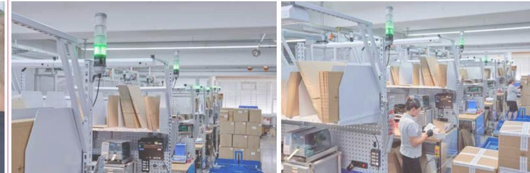
Avec AndonSPEED, vous optimisez vos processus sur les postes d'emballage et d'expédition. AndonSPEED vous indique ainsi visuellement où se trouvent les problèmes et leur nature. La correction rapide des erreurs permet des économies de temps durables. Grâce à une mise en réseau radio, le système signale une situation au poste de travail, au poste de contrôle central ou, si nécessaire, en envoyant un message par e-mail.
